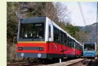
箱根登山ケーブルカーは、つるべ式(交走式)といえます。山頂の機械室に設置した巻上装置で片方のケーブルカーを引き上げます。これによりロープで結ばれた反対のケーブルカーが下りていくこととなります。なお、運転は自動で行われ、山頂の運転室にて監視・操作を行います。
