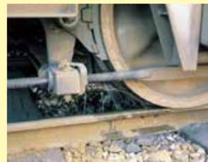
登山電車には散水タンクがあり、走行中、車輪とレールの間に水を撒きながら進みます。これはレールの摩擦を防ぐためです。ほかの鉄道では油を塗りますが、登山電車は急勾配のため、油では車輪が滑ってしまいます。ちなみに強羅駅での給水は山の湧き水を利用しています。実は登山電車は環境にもやさしいのです。
